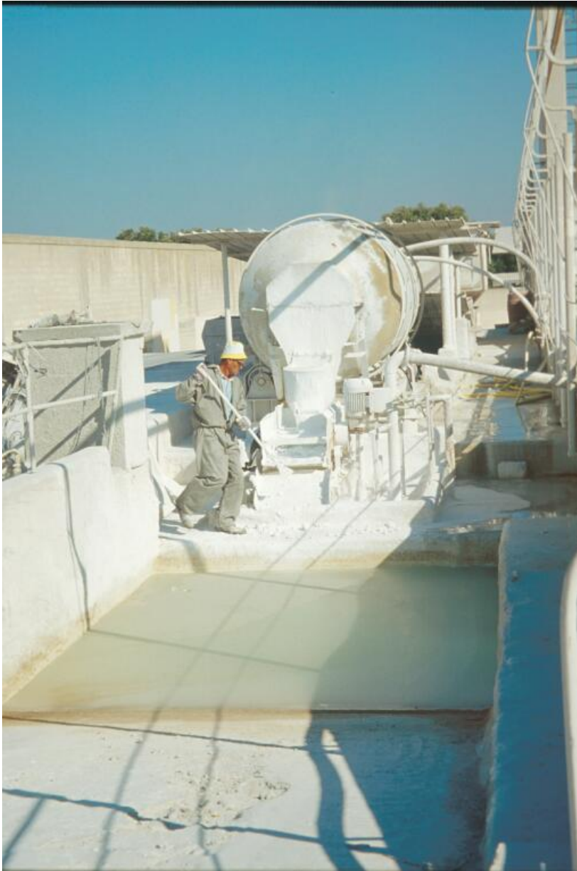
Processo de extinção da cal viva em cal em pasta em Itália (fotografia cedida pela arquitecta Ewa Malinowski)
